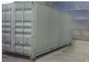
Aplicación de curado rápido Interzinc® 22 y capa de enlace/capa intermedia en el día 1
