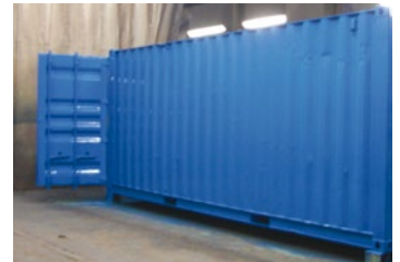
Aplicación de capa de acabado Interthane® 990 completado en el día 2
