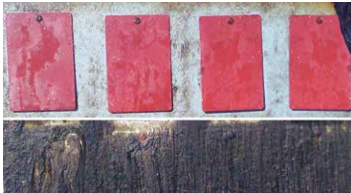
Intersleek 970 panneaux (en haut); Panneaux peints avec primaire anticorrosion (en bas) après immersion dans l' eau de mer pendant six mois
