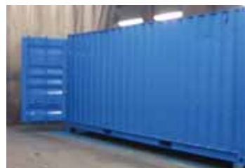
Aplicação da demão de acabamento de Interthane® 990 concluída no 2º dia
