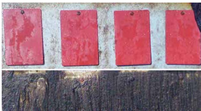
Painéis de Intersleek 970 (acima); Painéis anticorrosivos depois de seis meses imerso na água do mar (abaixo)
