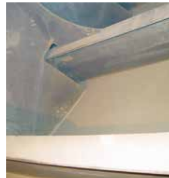
Прекрасное состояние покрытия балластного танка после 15 лет службы. Intershield 300 не разрушается на кромках.
