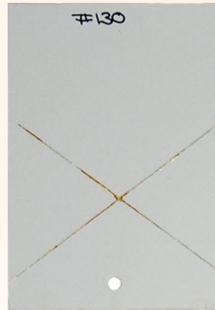
Zinc/ 349QC Système à 2 couches 9 mils (225 microns)
