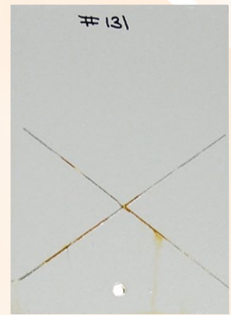
Zinc/Époxy/Uréthane Système à 3 couches 9 mils (225 microns)
