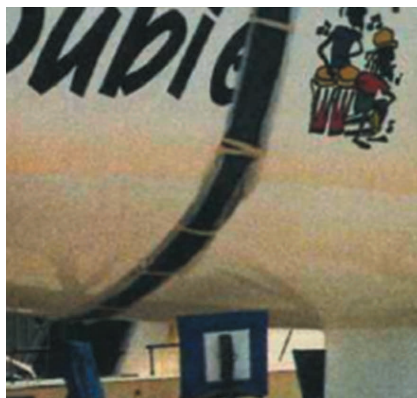
Løftestropperne er viklet i plastik, og bukkens blokke i tæppe for at beskytte coatingen
